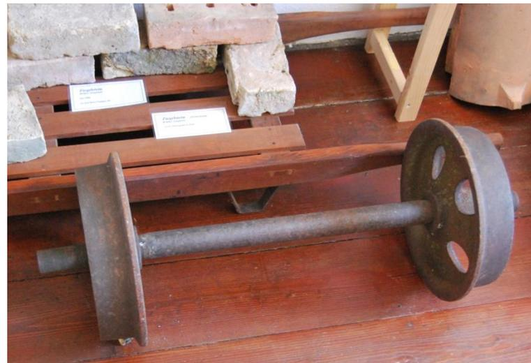
Radachse einer Kipplore der Erdtransportbahn von den Ziegeleien zu den Verladestellen am Rhein, später auch an den Bahnhof.
